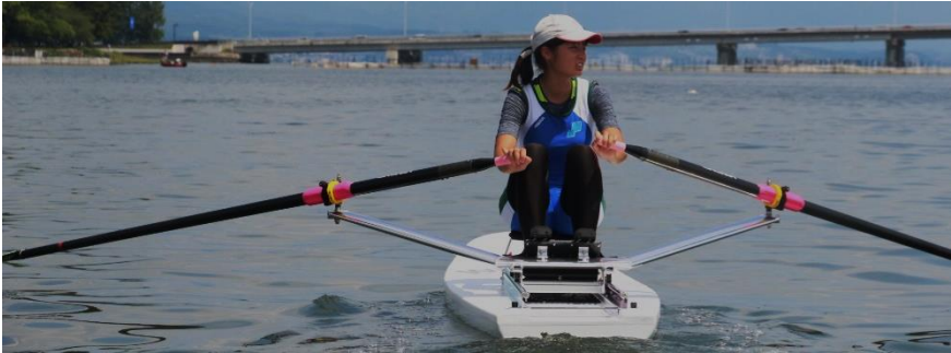
サーフボードのような平らな船体に、ロウイングユニットを取り付けたロウボード
