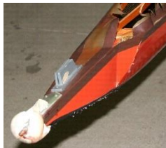
中:右:衝突によるバウ・ボールの損傷・突出し事例
